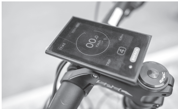
Parametry jazdy, poziom naładowania baterii i moc wspomagania kontroluje się przy użyciu dużego wyświetlacza
